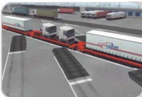
Carga e descarga é rápida (20 min) e independente do nº camiões
