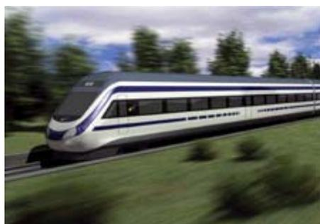
O comboio de duplo-eixo CAF-Alstom com  $V_{\text{máx.}} 275 \text{ Km/h}$  irá percorrer Porto-Madrid (535 Km) em 3 Horas ou menos. Possui tecnologia mais avançada para mudar bitola a 30 Km/h que seria efectuada perto de Aveiro
